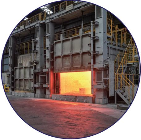
말은 간단하지만 아이디어 도출부터 기술 개발, 신규 장치를 설계, 사전 검토, 시공, 조업 조건 도출, 안정화까지 전 팀원이 사활을 걸고 맡은 역할을 수행한 끝에 달성한 성과였다. FGR은 보일러에서는 많이 사용되고 있는 기술로, 대형 산업용 가열로에 적용된 사례는 없다 보니 새롭게 설계 및 개발하는 데 많은 시행착오를 겪었던 것. 하지만 업적상 수상팀은 물론 모든 관련 팀의 협업을 통해 극복할 수 있었다. “저NOx 버너 국내 개발 및 설비 개선을 추진하는 과정에서 여러 어려움이 있었습니다. 국내 제작 사례가 없다는 점이 가장 큰 걸림돌이었습니다. 이에 따라, 국내 버너 제작 업체와 사전 실험과 협업을 통해 국내 최초 저NOx 버너 제작을 시도했죠.”
